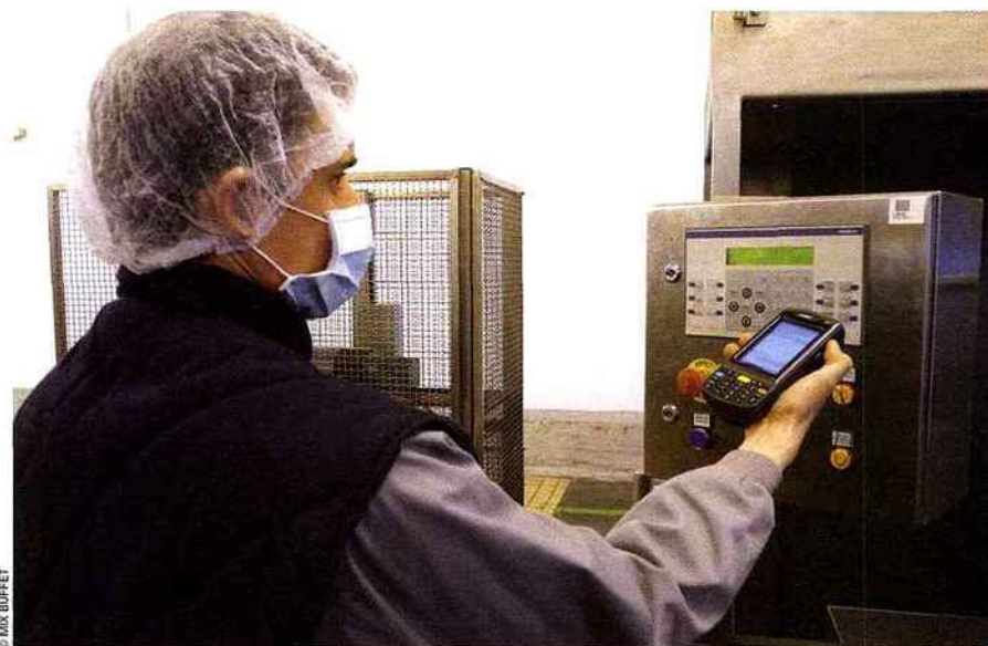
Lors d'une intervention de maintenance, le technicien scanne le code-barres de la machine puis rentre dans son PDA les symptômes de la panne, les causes identifiées, la nature et la durée de l'opération.
