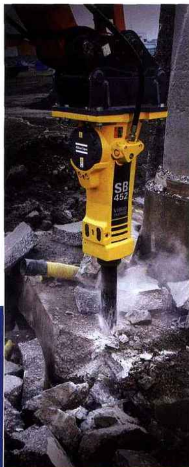
Réf. 0404 - Marteau hydraulique léger SB 452 d'Atlas Copco
