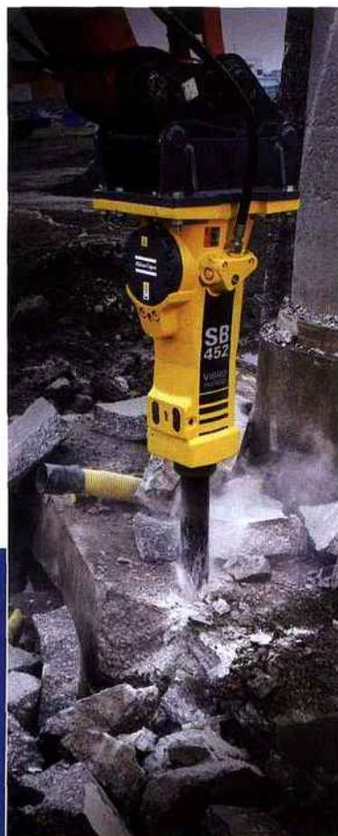
Réf. 0404 - Marteau hydraulique léger SB 452 d'Atlas Copco
